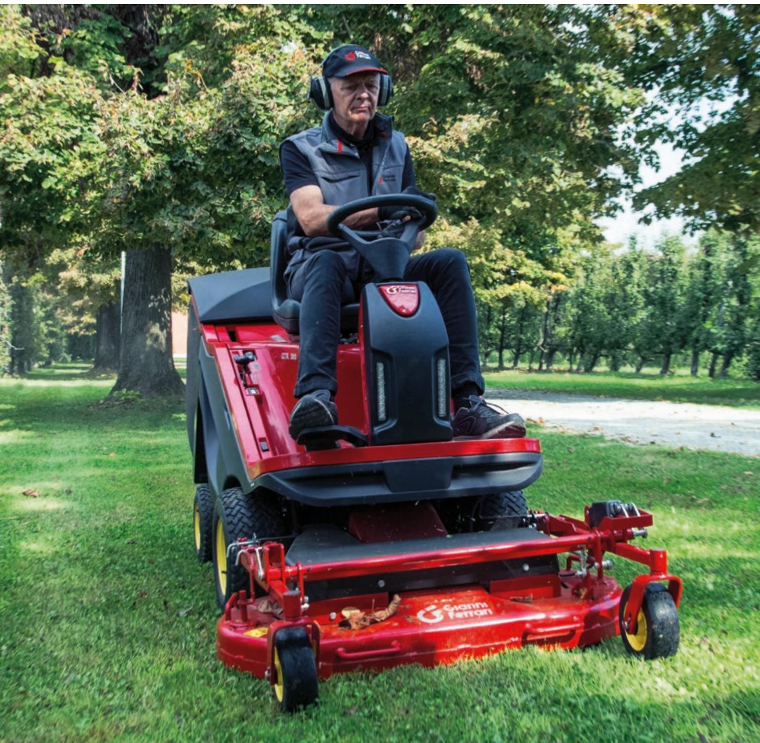
Il piatto offre una larghezza di taglio di **112 cm**, è **flottante** per adattarsi naturalmente alle ondulazioni del terreno, ed è dotato di **ruote anti-foratura** in gomma piena.
